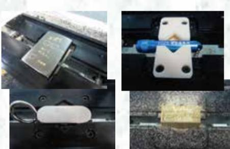
標準の口金だけで小判型訂正印から最大36mmサイズの角印まで固定できます。さらに脱着式の口金を使えばキーホルダー等の異形筒材やプレート、位牌等も手早く正確に固定出来ます。
