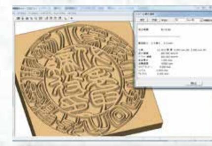
輪郭から彫削のパスを発生させたのち、パスデータは加工機に送る前にシミュレーションで加工結果を確認できます。また加工にかかるトータル時間もあらかじめ計算されるので、貴重な印材のロス無くし、時間の節約も可能になります。
