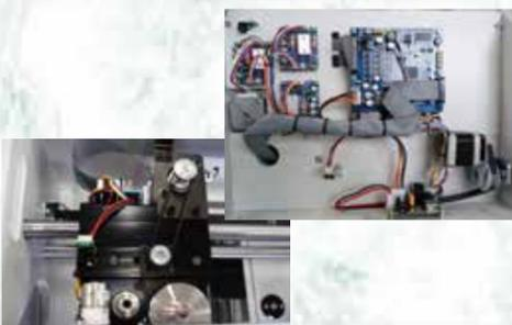
万一、消耗部品等に起因するトラブルが発生してもユーザー自身で簡単に部品交換できるアッセンブリ構造により、シャットダウンする時間を短縮し、メンテナンスにかかるコストを大きく削減することが図れます。
