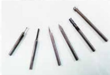
印章彫刻用の半割れ刃や両直菱刃から面訂専用刃、切り抜き用のスパイラル刃、曲面削り出し用のテーパボールエンドなど、実績に即して様々な加工に対応する高精度な工具は、すべて自社で製作し再研磨も行っています。
