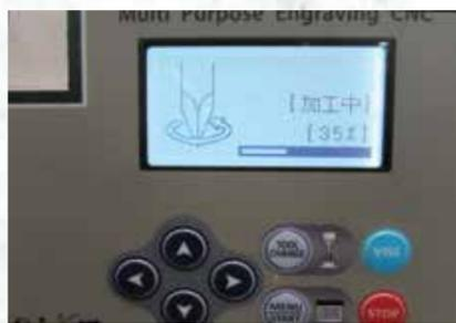
パソコンのシミュレーションでも確認するトータル加工タイムに加え、彫刻機本体の液晶パネルには加工時間の経過分がリアルタイムでいつも表示されるため、段取り良くスマートに作業につながります。
