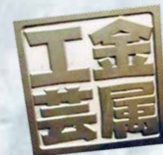
真鍮 2mmT 25度彫刻一枚刃 クランプ固定
