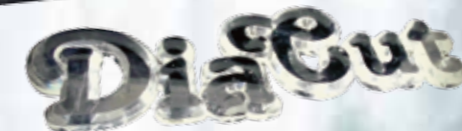
押し出し亚克力 10mmT 端面 30度ダイヤー一枚刃 外周 2mmダイヤストレート
