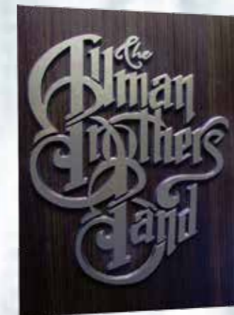
アルポリ 3.5mmT 25度彫刻一枚刃 ダイノック化粧板に貼り付け
