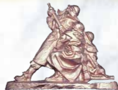
低発泡塩ビ 15mmT 6度テーパードミル メタリックスプレー塗装
