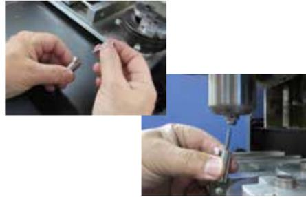
繰り返し精度の高い刃長センサーはLEDの点滅で目視確認できるため、簡単にZ原点を設定することができます。
