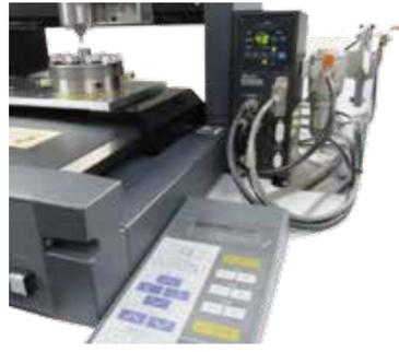
面倒だったツールの交換もスパナを使わずエアバルブで自動開閉式するコレットと、新開発のセットフリーホルダがあるので、誰でも簡単に刃物が交換できます。
