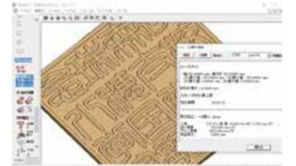
加工前に加工時間を計算して表示する機能と、使用する工具の加工結果を3D表示するシミュレーション機能を業界で唯一備えていますから、ロスのない加工と正確な見積りに役立てられます。
