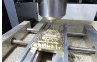
チタンやステンレス、真鍮でも微細な彫刻をする場合は、刃先を保護する為、霧状に飛散した切削ムースオイルを材料面に塗布します。
