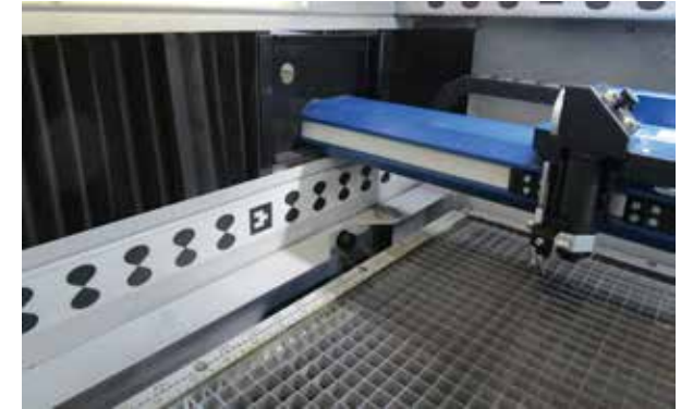
駆動系をヤニから守る密閉構造
