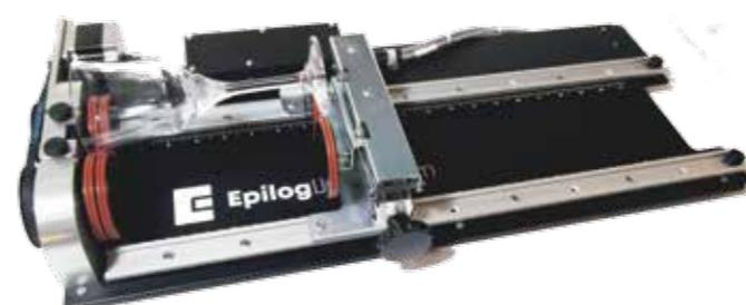
リムスタイルの回転アタッチメントは、ボトル、グラス、懐中電灯、またはその他の円筒形の素材に全周彫刻するオプションユニットです。このロータリーユニットは、ゴムローラーの上に製品を載せて、アジャスタハンドルで傾斜を調整することで彫刻領域面の水平を作り出しまで平面と同じ感覚で彫刻を可能にします。
