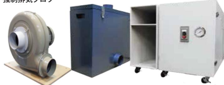
樹脂や木材を加工する際に発生する煙と塵埃は機内に滞留しないように静圧プロワーで吸い出す必要があります。排気を屋内などに出す場合はさらにフィルターと活性炭によって脱臭することで作業環境を改善します。
