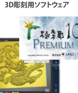
三次元CADやCGで作ったモデルおよび3Dスキャナで取り込んだ3Dデータは、高低差をグレースケールの濃淡に変換してレーザーに出力できる彫刻ソフトの極楽彫Premium10が大変便利です。
