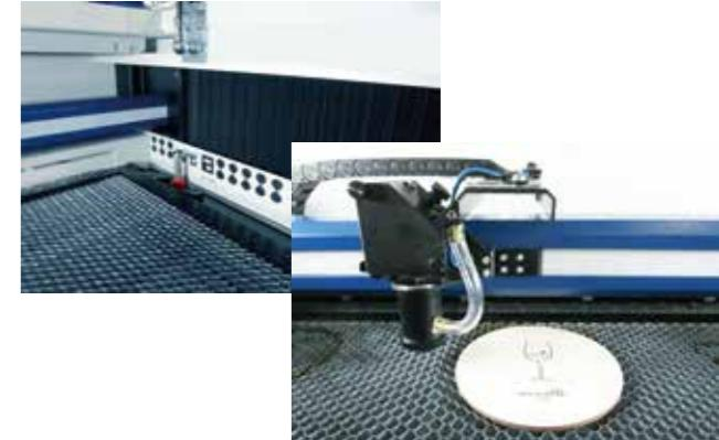
X軸アームの両サイドは蛇腹型のカバーでシールドし、アームの内面には素早い往復動作に連動するベルトタイプのカバーを装備して駆動系に煙が回り込むのを遮断しています。ヘッド部分も完全にカバーされたレンズアッセンブリ構造を持ち、マシンの駆動系と光学系は高いレベルで密閉性を維持しています。
