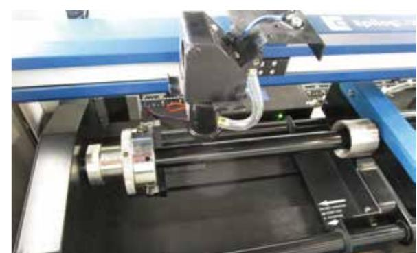
三つ爪チャックのロータリーユニットは、筒状の素材だけでなく多角形や非円筒形の小さな素材などでも機械的にしっかりと固定出来ます。彫刻で正確に位置決めする必要がある場合には最適なオプションです。
