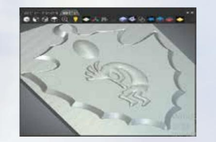
使用工具が実際に材料を彫刻した結果をワンタッチで三次元表示できるシミュレーション機能と加工時間予測機能が標準搭載されています。
