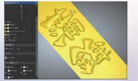
文字や閉図形の輪郭はそのZ断面を形状定義するだけで簡単に盛り上げ彫り下げ、平面落とし等の3D形状に立体化できます。
