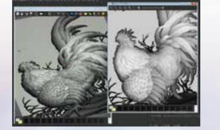
ハイトマップのグレースケールから3Dレリーフに変換したり、画面上の3Dモデルを2Dグレースケール画像に、ワンタッチで変換出来ます。
