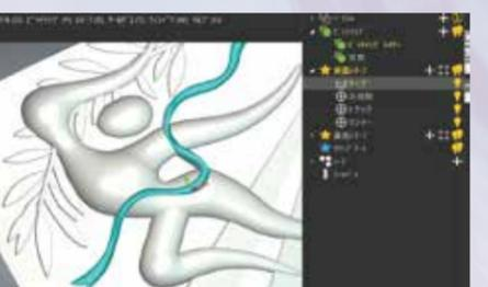
ベクトルやビットマップの多層構成に加えて、ArtEsperではレリーフを部分ごとにレイヤー分けして個別に編集と移動、合成することが出来ます。
