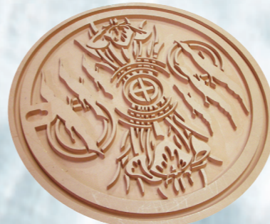
サンモジュール 15mmT 25度彫刻刃 先端径4mm/1.2mm/0.3mm
