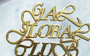
真鍮 2mmT 25度彫刻一枚刃 クランプ固定
