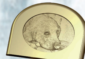
キャストアクリル 15mmT 20度0.3R半割テーパードミル メタリックスプレー塗装
