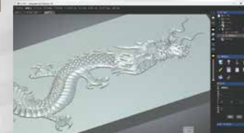
3D フィーチャー加工 3D モデルに投影されたツールパスがいきなり生成される機能です。全面加工に比べて圧倒的に少ないパスで立体モデルを彫刻できます。
