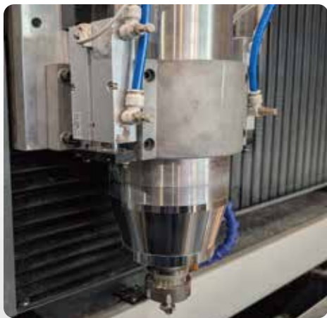
毎分 24000 回転の高出力、7.5kw の水冷式スピンドル
