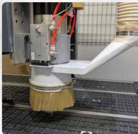
微粉末の拡散と駆動系への切り粉の侵入を、スピンドルを包み込んで上下開閉する集塵ダクトがしっかりと防御
