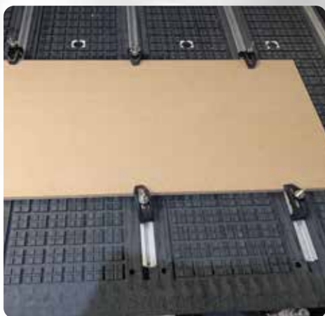
クランプ固定とバキューム式の両方に対応できる使い勝手の良いワークテーブル
