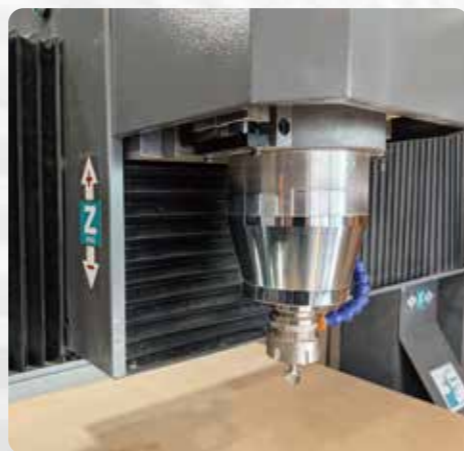
XYZ 軸全ての駆動系を加工時の切り粉や粉塵から守るベロース(蛇腹)カバー
