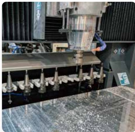
最大で 12 本まで並列装備を設定出来る固定番地のツールチェンジャが標準装備されます。
