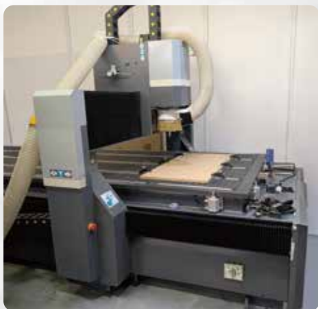
ガントリー構造の精度を向上させる目的で、Y 軸の両端を同期駆動するツインサーボモーター制御を採用
